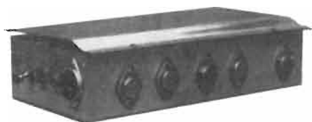
Questo contenitore contiene l'alimentatore e gli stadi di potenza nella versione stereofonica.
