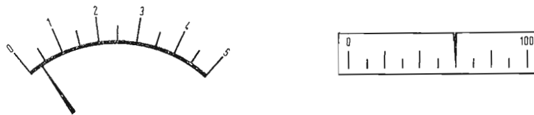
Fig. 1 - a) Il misuratore convenzionale a scala unica presenta una deviazione di seconda lettura ai bassi carichi (ad es. 300 mA). b) Il misuratore a portate ottimizzate consente la lettura accurata di 300 mA da una sorgente di 5 A.
